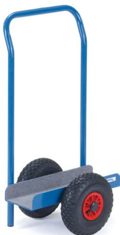
Construction en tôle d'acier, revêtement époxy bleu RAL 5007. Support en U recouvert de feutre de protection et dossier de poussée. Largeur support : 150 mm , largeur totale : 380 mm. Roues gonflables.
