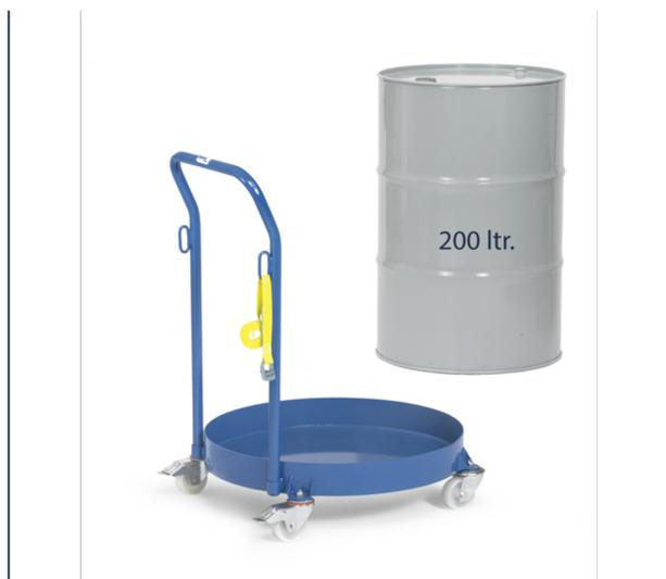
Ensemble mécano-soudé, revêtement époxy bleu RAL 5007. Rouleur pour le transport vertical de fûts en tôle contenance 200 litres. Rouleur étanche en tôle d'acier soudée. Ø interne 630 mm, rebord de 80 mm. Avec dossier de poussée à boulonner muni d'oeillets et d'une sangle d'arrimage. 4 roues pivotantes dont 2 avec freins en polyamide, roulement à palier lisse.
