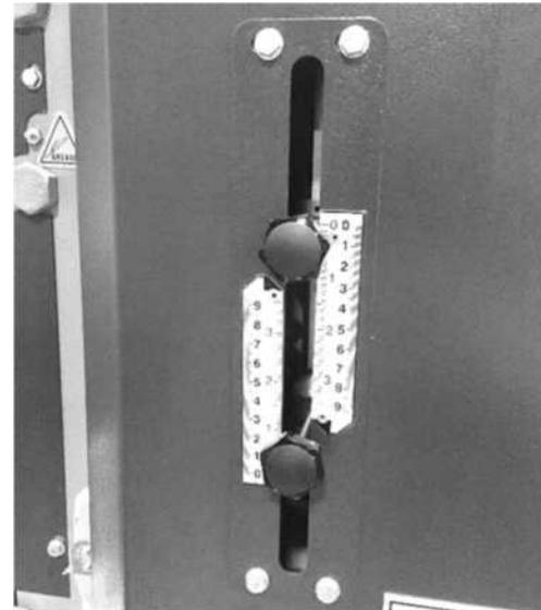
La bague supérieure (A) empêche les cisailles de descendre, la bague inférieure (B) empêche les cisailles de monter.
