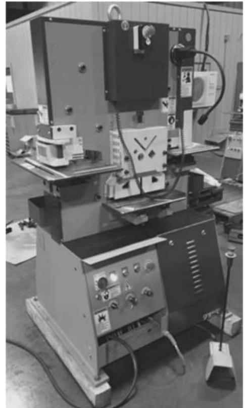
*La machine a un boulon à œil (A) sur le dessus permettant de soulever la machine avec une grue à portique*
