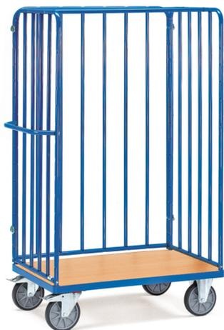
Ensemble mécano-soudé, revêtement époxy bleu RAL 5007. 1 plateau fixe en mélaminé surface effet hêtre. Ridelles avec tubes verticaux distancés de 130 mm. 1 grand côté à suspendre dans inserts. 2 roues pivotantes et 2 roues fixes à bandage TPE, moyeu à roulement à billes central. Freins sur roues pivotantes conformément à la Norme 1757-3 (Sécurité des chariots de manutention).
