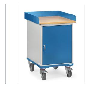
Placard roulant acier avec porte verrouillable. 1 plateau fixe et 2 amovibles. Plan de travail en mélaminé renforcé épaisseur 19 mm avec rebord sur 3 côtés de 80 mm. Revêtement époxy, caisson gris RAL 7035, armature et ouvertures RAL 5007. 2 roues pivotantes et 2 roues fixes à bandage TPE, moyeu à roulement à billes central. Freins sur roues pivotantes conformément à la Norme EN 1757-3. Charge maximum par étagère : 30 kg.
