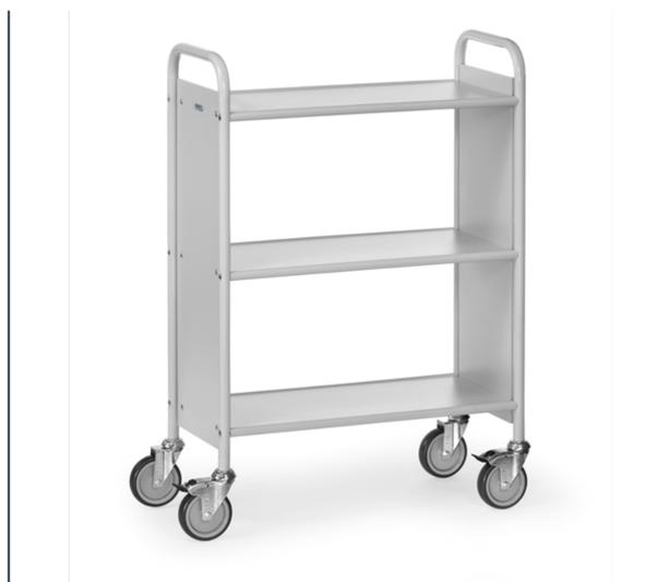
Ensemble mécano-soudé, revêtement époxy gris clair RAL 7035. 3 plateaux fixes. Longueur totale : 810 mm. Largeur totale : 385 mm. 4 roues pivotantes à bandage TPE élastique non traçant, moyeu à palier lisse. 2 roues avec freins conformément à la Norme 1757-3. Charge maximum par étagère : 50 kg.
