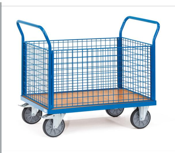
Ensemble mécano-soudé, revêtement époxy bleu RAL 5007, plateau en mélaminé surface effet hêtre avec 4 ridelles en treillis métallique 50 x 50 x 4 mm, hauteur petits et grands côtés 500 mm, grands côtés amovibles dont un boulonné. 2 roues pivotantes et 2 roues fixes à bandage TPE, moyeu à roulement à billes central. Freins sur roues pivotantes conformément à la Norme 1757-3 (Sécurité des chariots de manutention).
