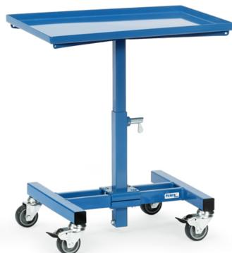
Pour bacs plastiques, corbeilles en treillis, etc. Construction en profilé et tube d'acier avec plateau en tôle avec rebord de 20 mm, non inclinable. Revêtement époxy bleu RAL 5007. Hauteur réglable au pas de 25 mm. Blocage par doigt d'indexage
