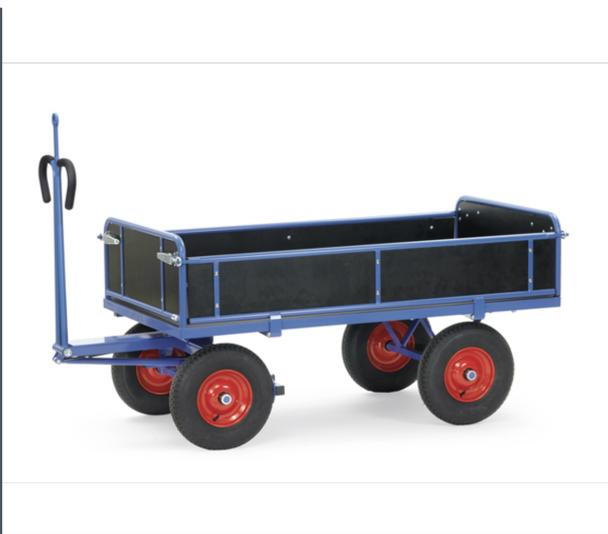
Ensemble mécano-soudé, revêtement époxy bleu RAL 5007. 4 inserts dans les angles, essieu sur rond à billes, timon en triangle avec poignée et revêtement en plastique, sécurisée remontant automatiquement en position verticale. Avec oeillet de traction, Ø interne 32 mm. Plateau en contreplaqué avec revêtement antidérapant et hydrofuge. Roues gonflables, moyeu à roulement à rouleaux. Freinage automatique sur essieu avant conformément à la Norme 1757-3.
