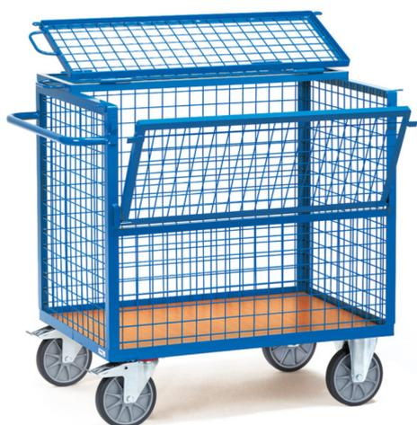
Ensemble mécano-soudé, revêtement époxy bleu RAL 5007. Habillage en treillis métallique 50 x 50 x 4 mm avec plateau en mélaminé surface effet hêtre. Couvercle à double battant et anneau pour cadenas. 2 roues pivotantes et 2 roues fixes à bandage TPE, moyeu à roulement à billes central. Freins sur roues pivotantes conformément à la Norme Européenne 1757-3 (Sécurité des chariots de manutention).
