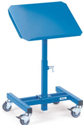
Construction en profilé et tube d'acier avec plateau en tôle d'acier et rebord de 20 mm sur un grand côté, revêtement époxy bleu RAL 5007. Pour bacs en plastiques, corbeilles en treillis etc.. Hauteur réglable au pas de 25 mm. Inclinable de 0°, 15° et 30°. 4 roues pivotantes à bandage TPE, moyeu à palier lisse. 2 roues avec freins.
