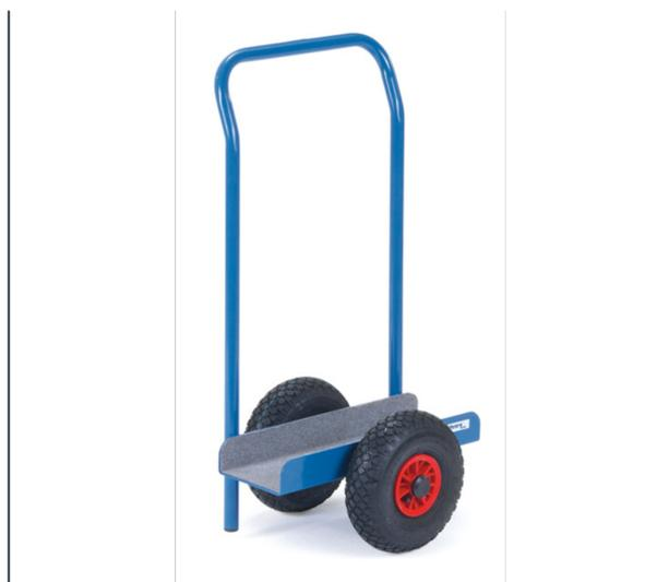
Construction en tôle d'acier, revêtement époxy bleu RAL 5007. Support en U recouvert de feutre de protection et dossier de poussée. Largeur support : 150 mm , largeur totale : 380 mm. Roues à bandage caoutchouc.
