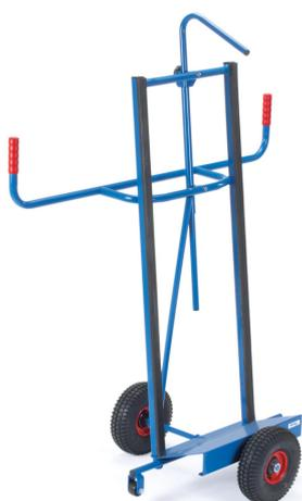
Construction en tube d'acier avec bavette tôle d'acier, protection antidérapante et système anti basculement des pièces, revêtement époxy bleu RAL 5007. Roues gonflables, moyeu à roulement à rouleaux. 2 galets de maintien Ø 50 mm. Pour le transport de panneaux de grandes tailles.
