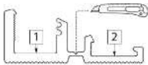
Le **rail en plastique** se compose lui aussi de deux parties. Détachez-les en passant avec un cutter dans la rainure.
