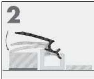
Placez maintenant la partie inférieure du profilé en aluminium dans le rail. L'aile du profilé se pose ainsi sur la partie la plus élevée du rail.
