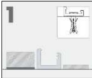
Fixez le rail au support à l'aide de vis. Placez les vis dans les trous pré-perçés du rail. Utilisez des vis de 3 x 30 mm.
