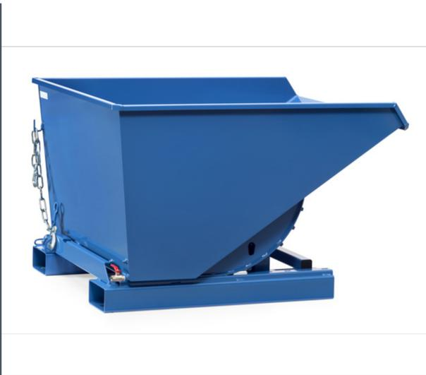
Construction robuste en tôle d'acier de 3 mm mécano-soudée et étanche. Revêtement époxy bleu RAL 5007. De serie avec passage de fourches. Versement sans risque de basculement, verrouillage anti-ouverture et chaîne de sécurité. Système d'ouverture par câble ramené au siège du conducteur. Robinet de vidange pour séparer les liquides des solides, n° d'article complété par un A. Livrée avec câble. Roues en option.
