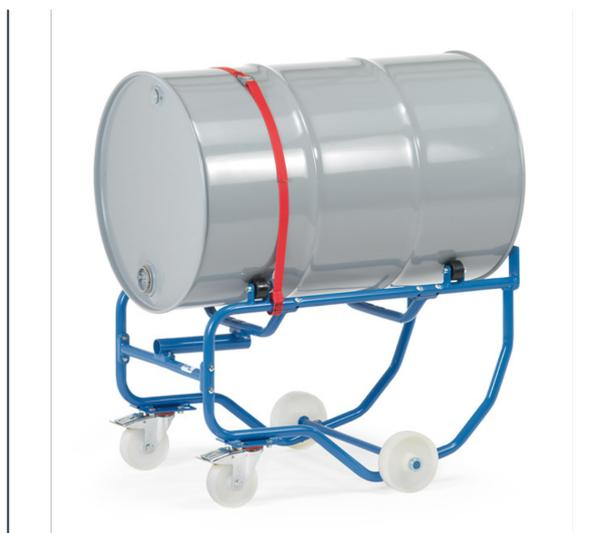
Construction en tube d'acier boulonné, revêtement époxy bleu RAL 5007. Berceau à fûts complet avec roues, levier de manutention et galets de rotation du fût. Prise en charge des fûts sans matériel de manutention mais grâce au levier et au basculement du berceau. 2 roues pivotantes en polyamide Ø 125 x 38 mm avec freins et 2 roues fixes en polyamide Ø 150 x 40 mm. Dimensions hors tout (L x l x H mm) : 900 x 615 x 600 mm.
