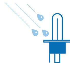
Seules des lampes en verre quartz (filament 2 650 °C, verre 800 °C) peuvent résister à d'importants chocs thermiques, par exemple lorsqu'une goutte d'eau froide entre en contact avec une lampe brûlante alors que vous conduisez avec un phare cassé.
