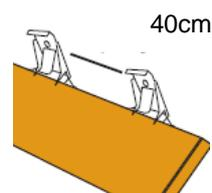
Le dessin ci-dessous indique les endroits où les clips doivent être fixés à la plinthe.
