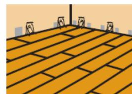
Attention ! L'utilisation des clips Quick-Step® a des conséquences sur la découpe en biais. En effet, à cause des clips, la plinthe est un peu inclinée. Utilisez l'accessoire fourni pour scier vos plinthes selon un biais parfait (voir dessin).
