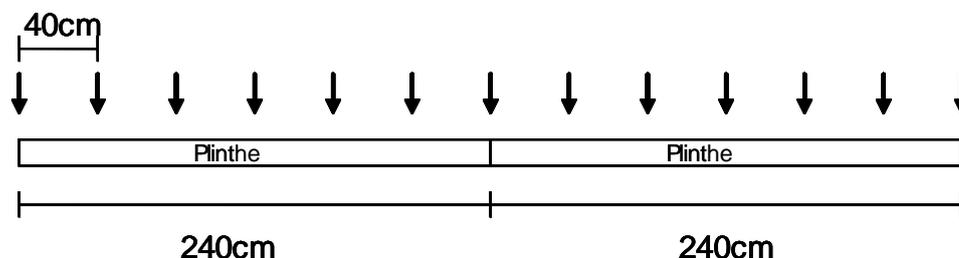
Remarque : pour des murs inégaux, il est recommandé d'utiliser davantage de clips. Si les irrégularités sont trop importantes, des ouvertures entre le mur et la plinthe sont inévitables.
