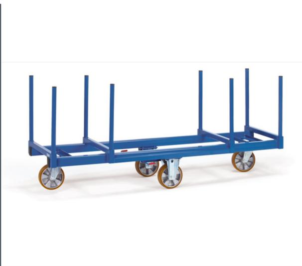
Ensemble mécano-soudé, avec barres en tube d'acier, revêtement époxy bleu RAL 5007. Armature ouverte, compatible pour pont et fourches de chariot. Roues en losange à bandage polyuréthane 200 x 50 mm, moyeu à roulement à billes. Freins sur roues du milieu. Largeur totale : 600 mm, largeur utile : 500 mm.
