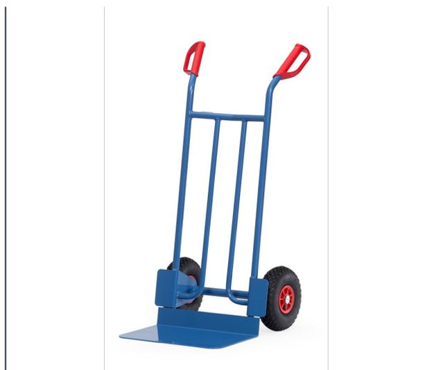
Ensemble mécano-soudé en tube et tôle d'acier, revêtement époxy bleu RAL 5007. Poignées de sécurité en plastique dur avec arceaux de sécurité. Bavette en tôle d'acier à boulonner et remplaçable. Roues à bandage caoutchouc, moyeu à roulement à rouleaux. Livré avec bavette démontée.
