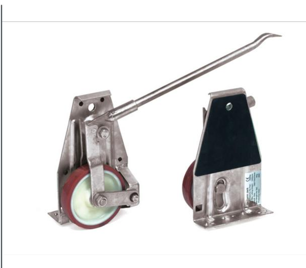
Armature en tôle d'acier zinguée. Surface en contact avec revêtement caoutchouc. Roues à bandage polyuréthane Ø 138 x 28 mm. Roulettes conçues pour le transport d'armoires lourdes.
