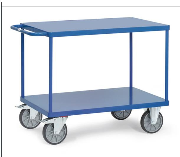
Système modulaire : ensemble mécano-soudé, revêtement époxy RAL 5007, assemblé selon le principe des "inserts fetra". Plateau en tôle d'acier soudé de niveau dans l'armature. 2 roues pivotantes et 2 fixes à bandage TPE, moyeu à roulement à billes central. Roues gonflables 220 x 70 mm en supplément. Freins sur roues pivotantes conformément à la Norme Européenne EN 1757-3 (Sécurité des chariots de manutention). Charge maximum plateau du haut : 200 kg.
