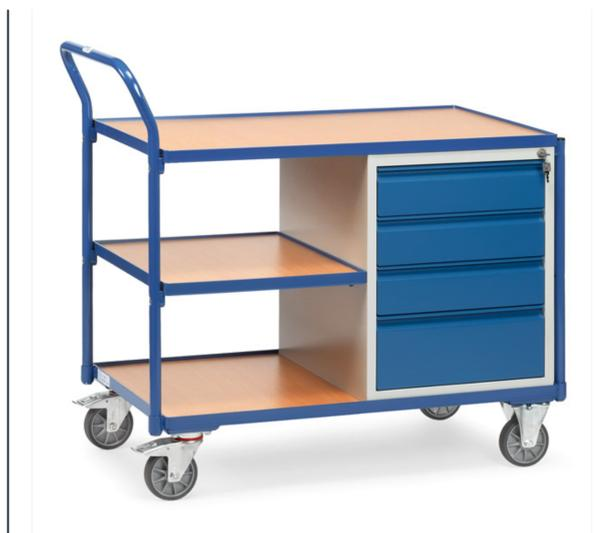
Ensemble mécano-soudé, revêtement époxy, caisson gris RAL 7035, armature et ouvertures RAL 5007. Plateaux en bois avec rebord de 12 mm de haut. 1 placard roulant avec serrure centrale (H X L X P : 600 x 500 x 600 mm) et 4 tiroirs (3 x 120 mm de haut et 1 x 180 mm de haut). Ouverture au 4/5. Charge par tiroir : 25 kg. 2 roues pivotantes et 2 roues fixes à bandage TPE, moyeu à roulement à billes central. Freins sur roues pivotantes conformément à la Norme EN 1757-3.
