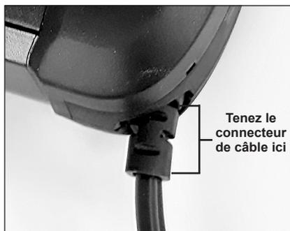
Pour ne pas endommager le câble de test de la batterie, tenez-le toujours par la partie moulée du connecteur d'extrémité (voir photo) lorsque vous l'insérez ou le retirez.
