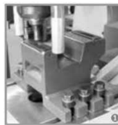
Met een speciale houder kunnen zowel de flens als het lijf worden geponsd.
