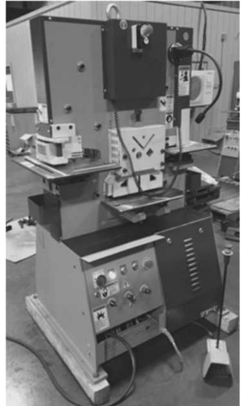
De machine heeft bovenop een oogbout (A) om de machine te heffen met een loopkraan.
