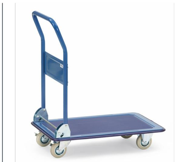
Chariot à plateforme en tôle d'acier avec revêtement antidérapant et bande de protection sur le périmètre. Dossier de poussée rabattable en tube, peinture époxy bleu RAL 5007. 2 roues pivotantes et 2 roues fixes à bandage caoutchouc. Freins sur roues pivotantes.
