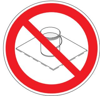
**Les seaux métalliques doivent toujours être mis à la terre :** raccorder un fil de terre au seau. Serrer une extrémité au seau et l'autre extrémité à une véritable prise de terre telle qu'une conduite d'eau.
