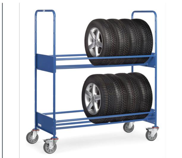
Construction en tube d'acier renforcé, revêtement époxy bleu RAL 5007. Supports de pneumatiques réglable au pas de 150 mm avec ridelle en tôle d'acier. Convient pour une utilisation plus intensive comme par exemple dans les box des écuries de voitures de courses. 4 roues pivotantes à bandage caoutchouc élastique bleu gris non traçant, moyeu à roulement à billes. 2 roues avec freins conformément à la Norme Européenne EN 1757-3 (Sécurité des chariots de manutention).
