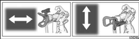
4. Serrez l'écrou de retenue à la main (25) après l'avoir ajusté au réglage désiré.
