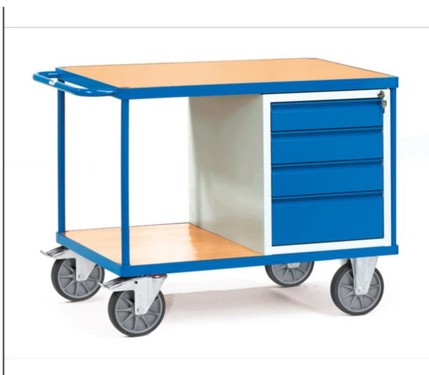
Construction en profilé et tube d'acier, revêtement époxy, caisson gris RAL 7035, armature et ouverture RAL 5007. Plateaux en bois, 1 placard à tiroirs à serrure centrale (H X L X P : 600 x 500 x 700 mm) avec 4 tiroirs (1 X 105 mm, 2 x 120 mm et 1 x 180 mm). Charge par tiroir : 25 kg. 2 roues pivotantes et 2 roues fixes à bandage TPE, moyeu à roulement à billes central. Freins sur roues pivotantes conformément à la Norme EN 1757-3.
