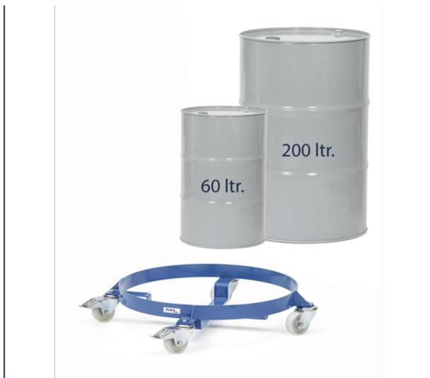
Ensemble mécano-soudé et construction en profilé d'acier avec un cintrage permettant d'embarquer soit des fûts de 60 litres ou de 200 litres, revêtement époxy bleu RAL 5007. Ø de 420 et 610 mm. 4 roues pivotantes dont 2 avec freins en polyamide, roulement à palier lisse.
