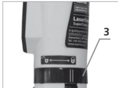
! Pour le transport ou pendant les périodes d'inutilisation de l'appareil, repliez les pieds (4), éteignez le laser (touche 1) et la sécurité de transport (3). Rangez ensuite l'appareil dans la pochette afin que l'appareil soit protégé de tout dommage.
