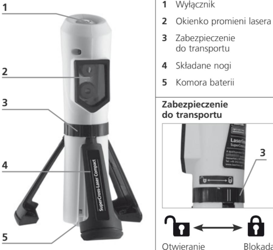
! Na czas transportu lub gdy urządzenie nie jest używane, złożyć nogi (4), wyłączyć lasery (przycisk 1) i włączyć zabezpieczenie transportowe (3). Następnie włożyć urządzenie do torby, aby zabezpieczyć je przed uszkodzeniem.
