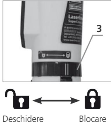
! Pentru transportare sau dacă aparatul nu este utilizat se pliază picioarele (4), se oprește laser-ul (tasta 1) și se blochează protecția pentru transport (3). În final aparatul se introduce în săculețul moale pentru protecția aparatului contra deteriorării.
