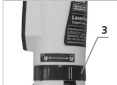
**!** Vid transport eller när apparaten inte behövs ska benen (4) fällas ihop, lasern stängas av (knapp 1) och transportsäkringen (3) spärsas. Lägg sedan apparaten i den mjuka väskan så att den skyddas mot skador.
