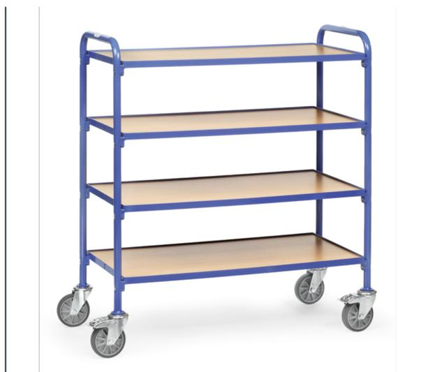
Ensemble mécano-soudé, revêtement époxy bleu RAL 5007. 4 plateaux en mélaminé surface effet hêtre avec rebord de 10 mm. 4 roues pivotantes à bandage TPE, moyeu à roulement à billes. 2 roues avec freins conformément à la Norme EN 1757-3. Charge par plateau : 60 kg. Livré sans bacs.
