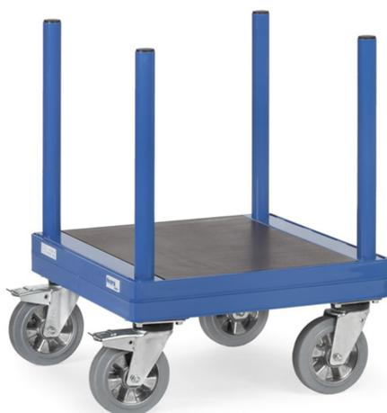
Ensemble mécano-soudé, avec barres en tube d'acier, revêtement époxy bleu RAL 5007. Plateau en contreplaqué plastifié hydrofuge et antidérapant. 4 roues pivotantes pour charges lourdes à bandage caoutchouc élastique, moyeu à roulement à billes. 2 roues pivotantes avec freins.
