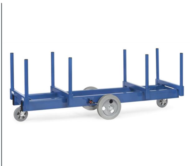
Ensemble mécano-soudé, avec barres en tube d'acier, revêtement époxy bleu RAL 5007. Armature ouverte, compatible pour pont et fourches de chariot. Roues en losange à bandage polyuréthane, au milieu 360 x 75 mm, au bout 200 x 50 mm, moyeu à roulement à billes. Freins sur roues du milieu. \_x000D\_
