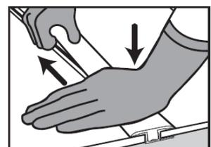
Pendant la pose du sol, veillez à laisser suffisamment d'espace entre les deux surfaces que le profilé doit raccorder. Tenez également compte du joint de dilatation indispensable entre les montants droits du rail (entre lesquels le profilé sera emboîté) et le sol. Sciez le rail en plastique à la bonne longueur et placez-le au centre, sur le support, dans l'espace laissé libre entre les deux sols. Il est possible de fixer le rail de différentes façons : voir plus loin. Appuyez doucement sur le
