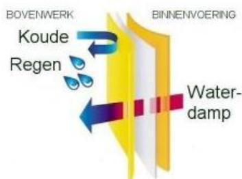
La partie PTFE de la membrane comprend plus de 1,4 milliard de pores microscopiques par cm<sup>2</sup>.
