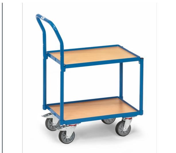
Construction en profilé d'acier, revêtement époxy bleu RAL 5007. 2 plateaux en mélaminé surface effet hêtre avec rebord de 15 mm et dossier de poussée, distance entre les plateaux : 400 mm. Hauteur totale : 970 mm. 4 roues pivotantes à bandage TPE, moyeu à roulement à billes central. 2 roues avec freins conformément à la Norme EN 1757-3. Compatible pour bacs plastiques 600 x 400 mm.
