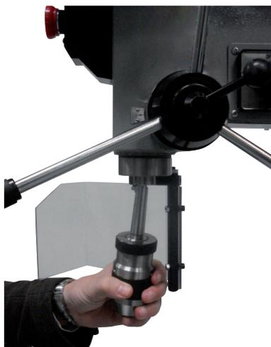
Abb. 9 - Bohrkopf festdrücken
