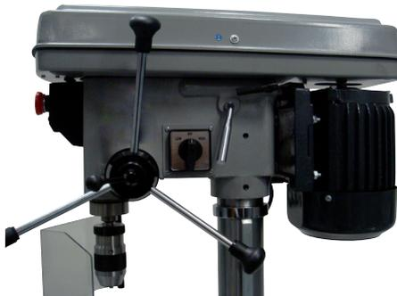
Abb. 7 - Knöpfe auf die Vorschubhebel montieren
