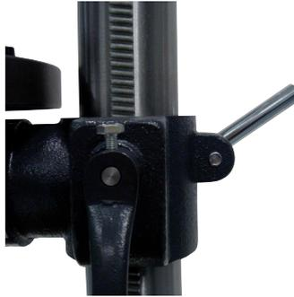
Abb. 5- Klemmbolzen anziehen
