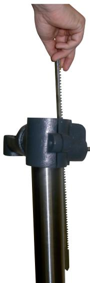
Abb. 2 - Zahnstange und Ring entfernen
