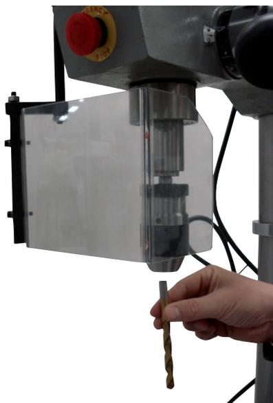
Abb. 17 - Bohrer einsetzen
