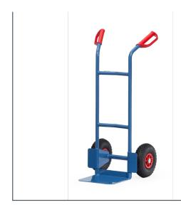
Ensemble mécano-soudé en tube et tôle d'acier, revêtement époxy bleu RAL 5007. Poignées de sécurité en plastique dur avec arceaux de sécurité. Bavette en tôle d'acier à boulonner et remplaçable. Roues gonflables, moyeu à roulement à rouleaux. Tablier cintré permettant d'embarquer des éléments ronds tels que rouleaux, bidons, seaux etc. Livré avec bavette démontée.
