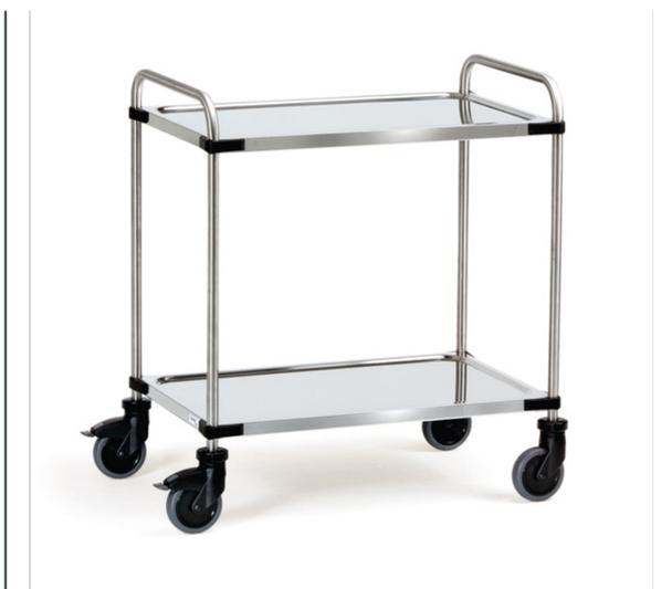
Chariot Inox avec tube en chrome-nickel-acier. 2 plateaux emboutis en chrome et acier avec isolant phonique. Armature avec pastilles de protection en plastique. 4 roues pivotantes inoxydables à bandage TPE élastique confortable et non traçant, moyeu à roulement à billes. 2 roues avec freins. Conformément à la Norme DIN 18867 partie 8. Charge maximum par plateau : 80 kg. Livré démonté, montage facile.
