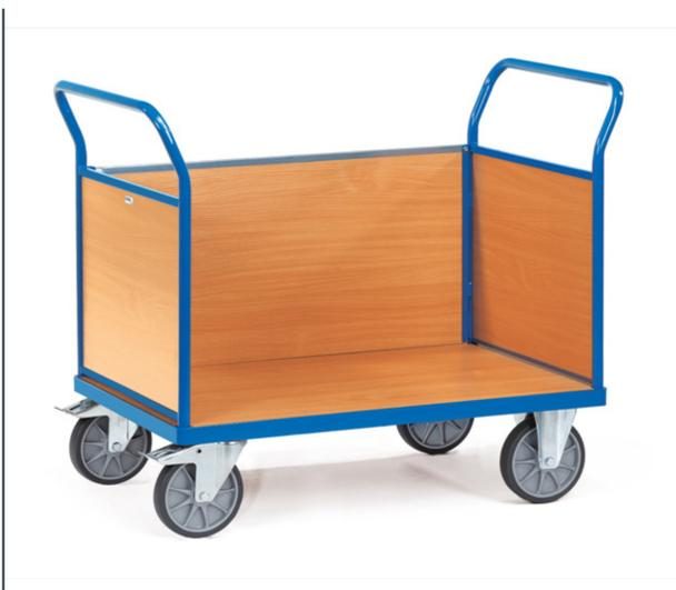
Ensemble mécano-soudé, revêtement époxy bleu RAL 5007, plateau en mélaminé surface effet hêtre avec 3 ridelles en mélaminé, hauteur petits et grand côtés 500 mm, grand côté boulonné. 2 roues pivotantes et 2 roues fixes à bandage TPE, moyeu à roulement à billes central. Freins sur roues pivotantes conformément à la Norme 1757-3 (Sécurité des chariots de manutention).
