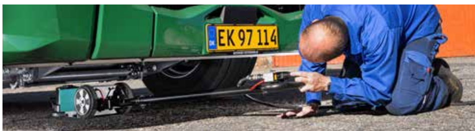
Mobiele, lucht-hydraulische telescopische krik met een uitzonderlijk groot bereik van 1800 mm.
