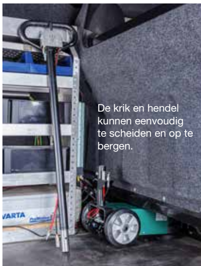
Mobiele, lucht-hydraulische telescopische krik met een uitzonderlijk groot bereik van 1800 mm.
