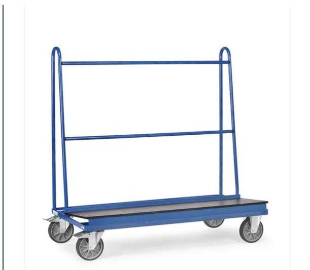
Ensemble mécano-soudé, revêtement époxy bleu RAL 5007, plateau en contreplaqué hydrofuge et antidérapant. 2 roues pivotantes et 2 roues fixes à bandage TPE 200 x 40 mm, moyeu à roulement à billes central. Freins sur roues pivotantes conformément à la Norme EN 1757-3 (Sécurité des chariots de manutention). Hauteur utile 1150 mm.
