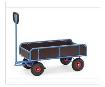
En tube d'acier soudé, revêtement époxy bleu RAL 5007. Ridelles hauteur 250 mm, Plateau et ridelles en contreplaqué hydrofuge. Essieu avec timon. Roues gonflables, moyeu à roulement à rouleaux. Poignée sécurisée avec revêtement souple remontant automatiquement en position verticale. Blocage automatique de l'essieu avant, conformément à la Norme EN 1757-3.
