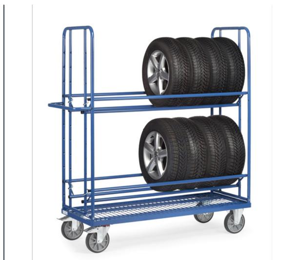
Construction en tube d'acier, revêtement époxy bleu RAL 5007. Plateau avec treillis métallique soudé 140 x 40 mm. Supports réglables au pas de 120 mm. L'articulation des supports permet une adaptation automatique au diamètre des pneumatiques. 2 roues fixes et 2 roues pivotantes à bandage TPE, moyeu à roulement à billes. Freins sur roues pivotantes conformément à la Norme Européenne 1757-3 (Sécurité des chariots de manutention).
