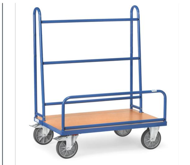
Ensemble mécano-soudé, revêtement époxy bleu RAL 5007. Plateforme en mélaminé surface effet hêtre. Armature en tôle d'acier à boulonner. 2 roues fixes et 2 roues pivotantes à bandage TPE, moyeu à roulement à billes. Freins sur roues pivotantes. Hauteur utile : 1 050 mm. Hauteur du tube cintré d'arrêt : 300 mm.
