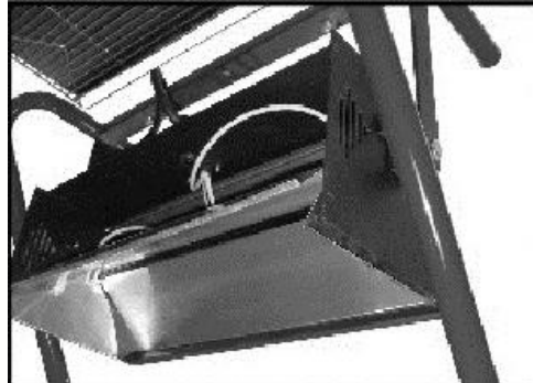
Afbeelding 5 – Demontage van de onderste afscheiding.
