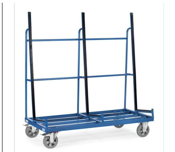
Pour un transport sécurisé des plaques de verres, bois et plastiques, ainsi que portes et fenêtres montées. Ensemble mécano-soudé, revêtement époxy bleu RAL 5007. Chariot à 1 face avec protection en caoutchouc. 2 roues fixes et 2 roues pivotantes à bandage caoutchouc élastique bleu gris non traçant, moyeu à roulement à billes. Freins sur roues pivotantes conformément à la Norme EN 1757-3. Largeur utile : 430 mm, hauteur utile : 1 450 mm. \_x000D\_
