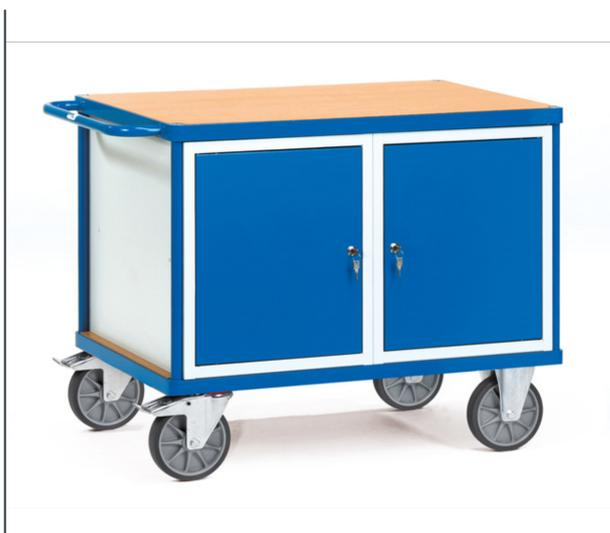
Construction en profilé et tube d'acier, revêtement époxy, caisson gris RAL 7035, armature et ouverture RAL 5007. Plateaux en bois, 2 placards verrouillables (H X L X P : 600 x 500 x 700 mm) avec portes et 1 étagère fixe et 2 amovibles. Charge par étagère placard : 30 kg. 2 roues pivotantes et 2 roues fixes à bandage TPE, moyeu à roulement à billes central. Freins sur roues pivotantes conformément à la Norme EN 1757-3.
